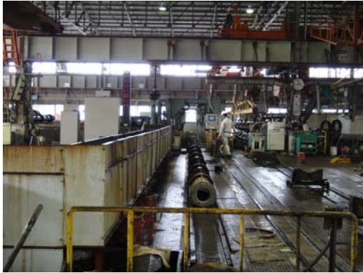
型枠にセットされたコン柱（遠心後）
