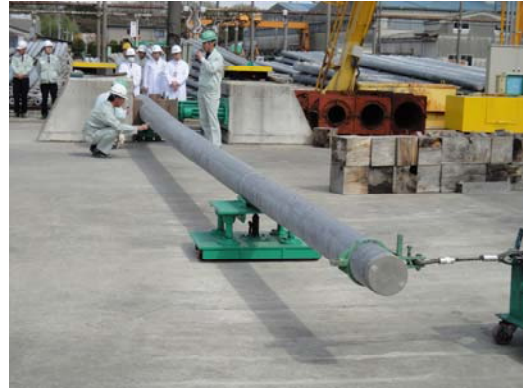
JIS の強度荷重試験（5kN）
