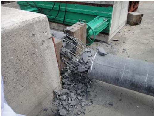
破壊強度試験の結果（コン柱破壊）
