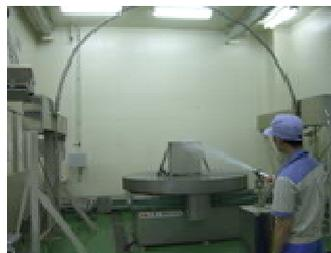
防塵試験室：IEC 規格（IEC60529）に規程されているエンクロージャ（外郭）の防塵性や防水性を確認する設備で、菊川ラボラトリでは IP 試験を行なう試験所として、（財）日本適合性認定協会（JAB）より ISO/IEC17025 に基づいた認定を取得しています。
